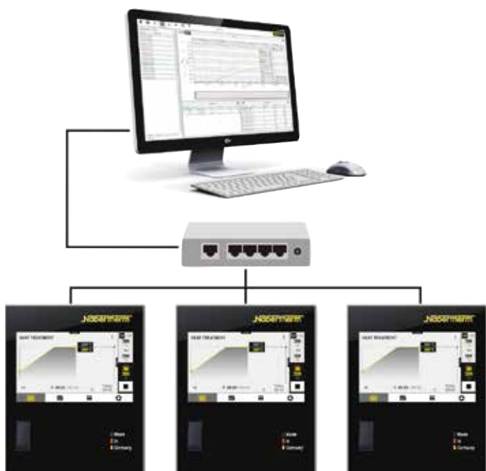
Exemple de montage avec 3 fours
