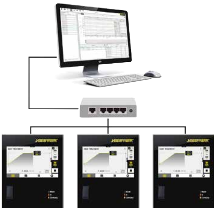
Przykładowa konstrukcja z 3 piecami
