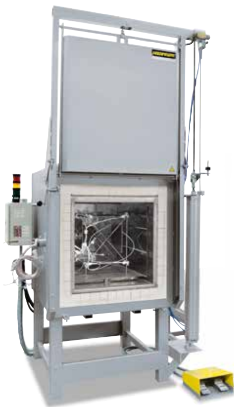
Stojak pomiarowy do wyznaczenia równomierności temperatury
