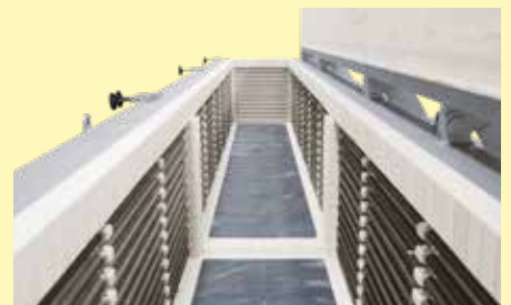
炉腔S 5120/GS带有支撑用于将炉腔分为两部分的隔板装置
