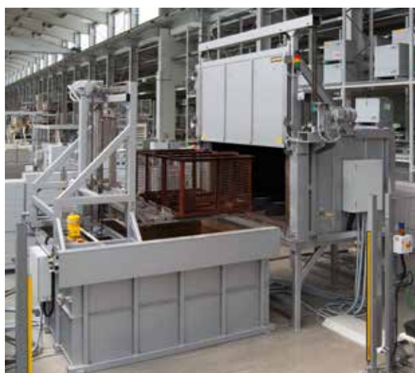
水平式调质设备由空气循环箱式炉、双轴式机械手和水淬水池组成。
