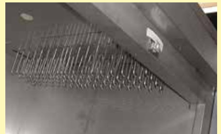
电加热炉上的封闭式加热线圈，最高温度为450℃和600℃
