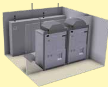
从洁净室装料的高温炉；开关设备和炉体安装在灰室
