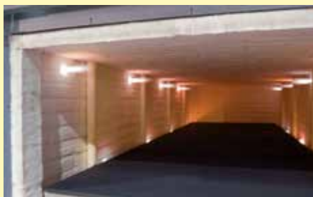
带有八个高速燃烧器的炉膛
