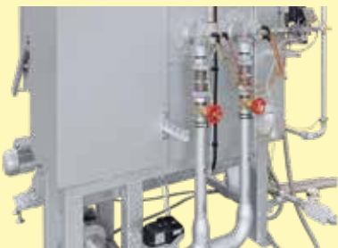
带两个燃烧器的燃气段位于炉后壁
