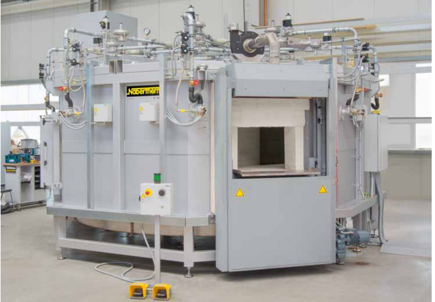
直接燃气转底炉，最高温度1100℃，用于模具预热
