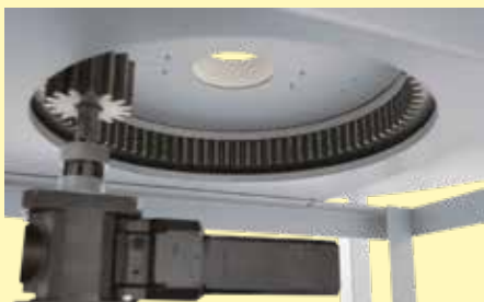
转底炉下设有齿轮圈驱动装置
