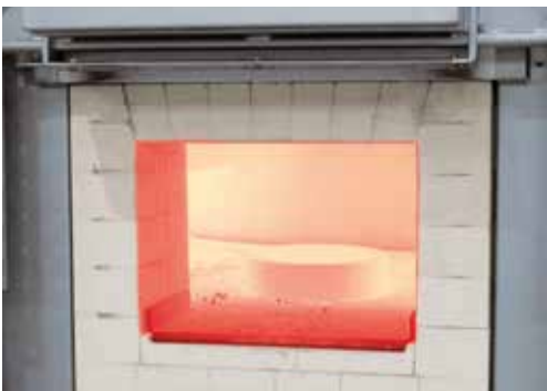
在转底炉中预热钢环用于锻造
