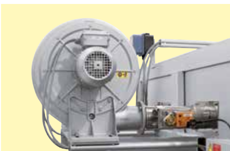
用于快速冷却的散热风扇
