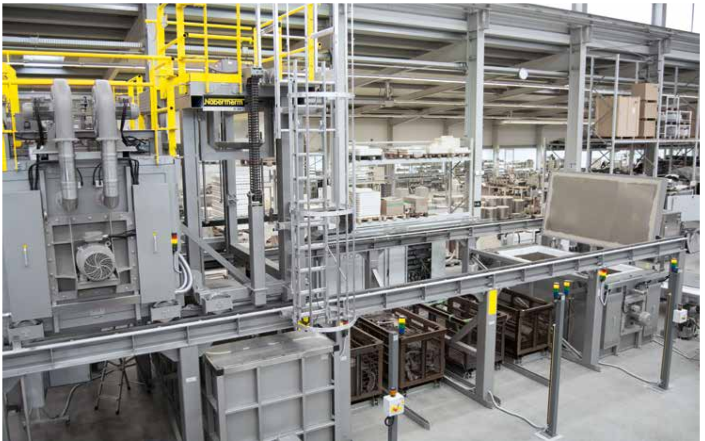
可移动式落底式炉用于固溶退火，包含带4个放置位的用于热老化处理的井式炉
