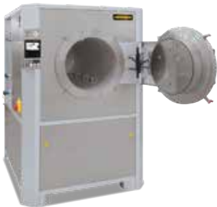
热壁罐式炉NR 80/11用于在完成3D打印后，在保护气体或真空条件下进行金属部件的去应力退火
