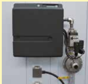
循环空气箱式炉采用气体加热，例如通过紧凑型燃烧器
