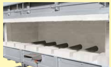
利用辐射管间接气加热
