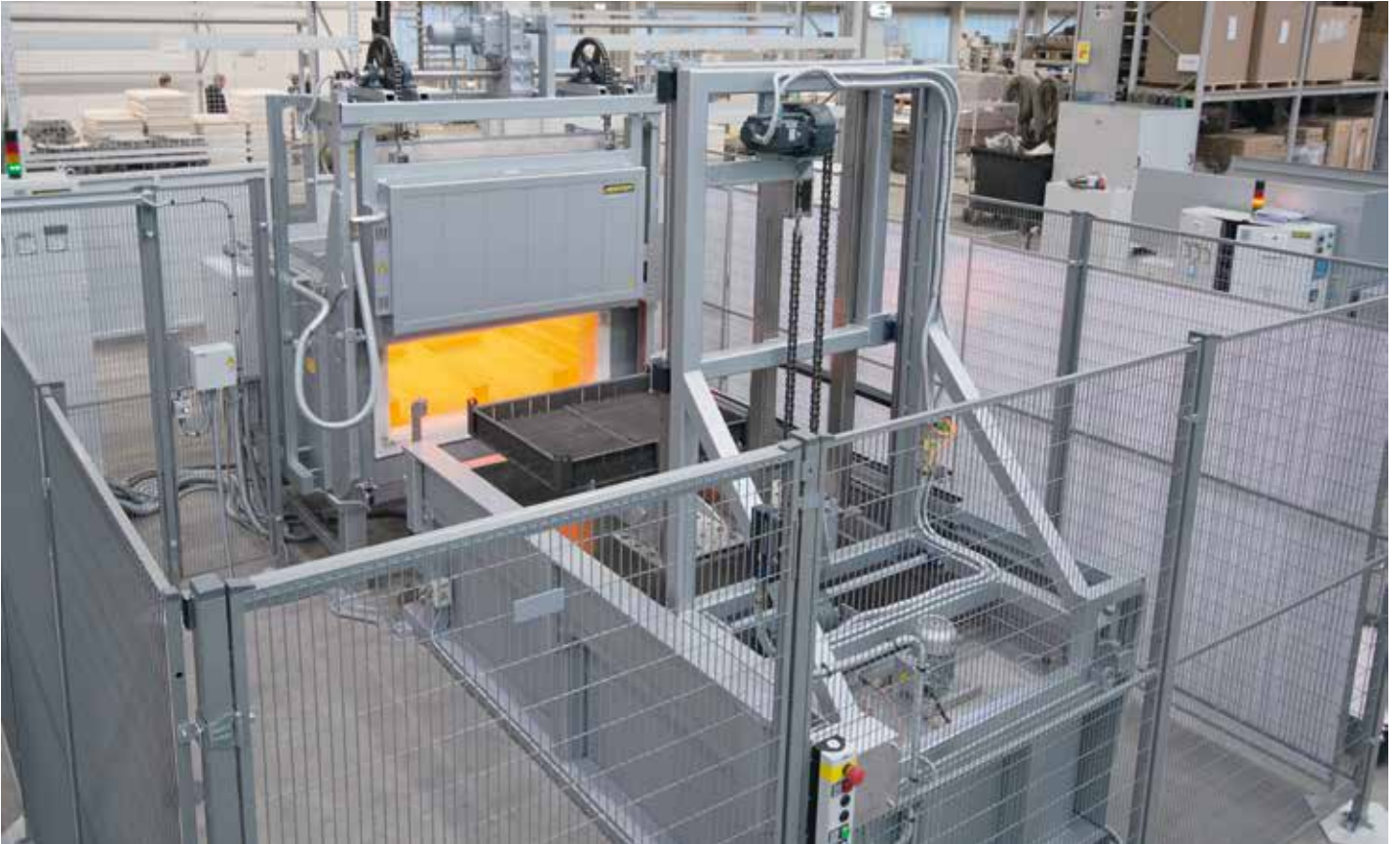
全自动调质设备由一个退火炉、水淬火池和双轴式机械手组成
