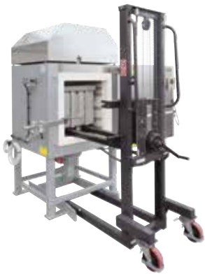
箱式炉LH 216/12用于在完成3D打印后，在保护气体条件下进行金属部件的去应力退火
