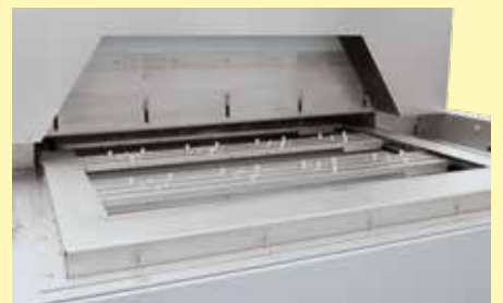
直通式炉D 1000/1250/200/26AS用于铸件的淬火处理
