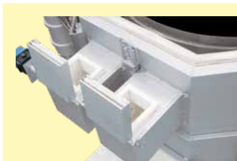
自动新鲜空气和废气挡板控制装置
