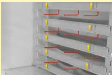
进气百叶窗板可调，用于调整吹向物料的空气的导向
