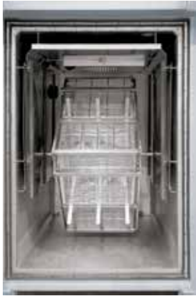
电机传动的旋转底架，带有内置篮筐，用于在热处理时移动装料
