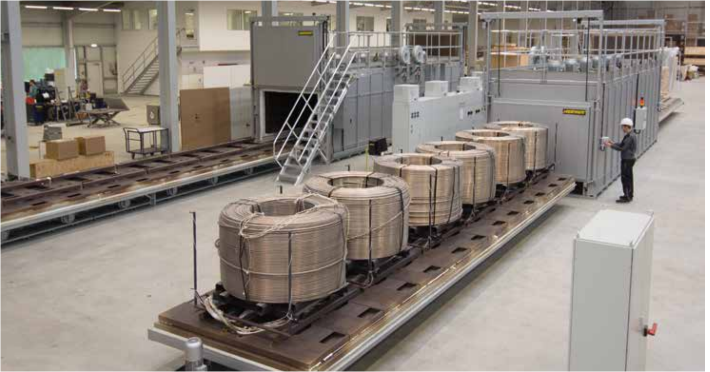
空气循环台车炉W 24750/60AS用于铝卷的退火
