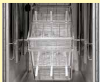
硅树脂回火炉内配有用于装料并被密封焊接的内盒以及旋转底架
