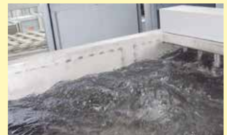
性能强大的淬火介质循环装置
