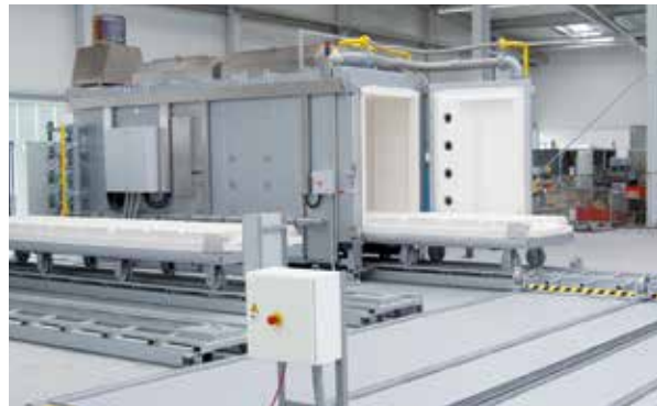
组合炉设备，由两个台车炉WB 11000/HS、台车移动系统和两个包括所需置放轨道的辅助台车
