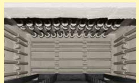
在作为用于金属板材的预热炉使用时，带顶盖加热装置的炉膛作为附加装备
