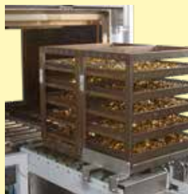
用于盘装散料热处理的连续炉
