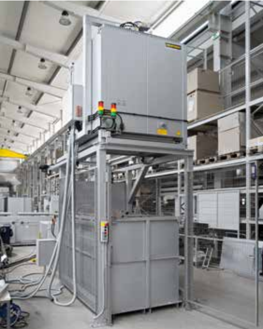
落底式炉设备带固定式淬火池（规格A）
