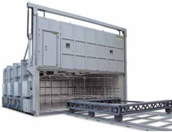
空气循环箱式炉N 140000/26AS用于在真空袋中固化纤维复合材料，含泵和炉膛内必要的接口
