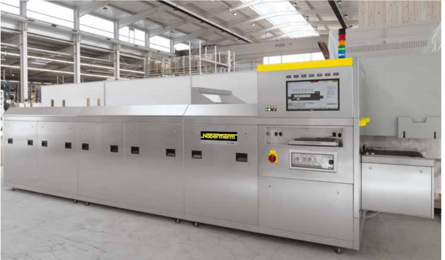
连续炉DF 36/320/5/10WK用于LTCC应用中的烧失和烧制/烧结
