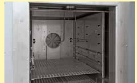
内膛有插入板、热电偶和压力监控
