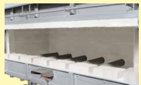
Calentamiento por gas indirecto con tubos de radiación
