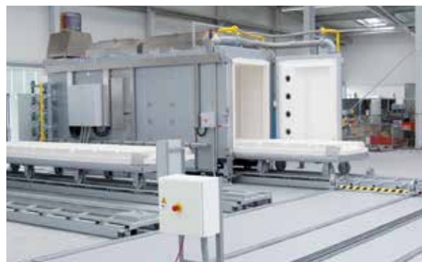
Horno combinado, compuesto por un horno de vagoneta móvil WB 11000/HS con calentamiento por gas, sistema de desplazamiento de vagonetas y dos vagonetas móviles adicionales, incl. los rieles de estacionamiento necesarios
