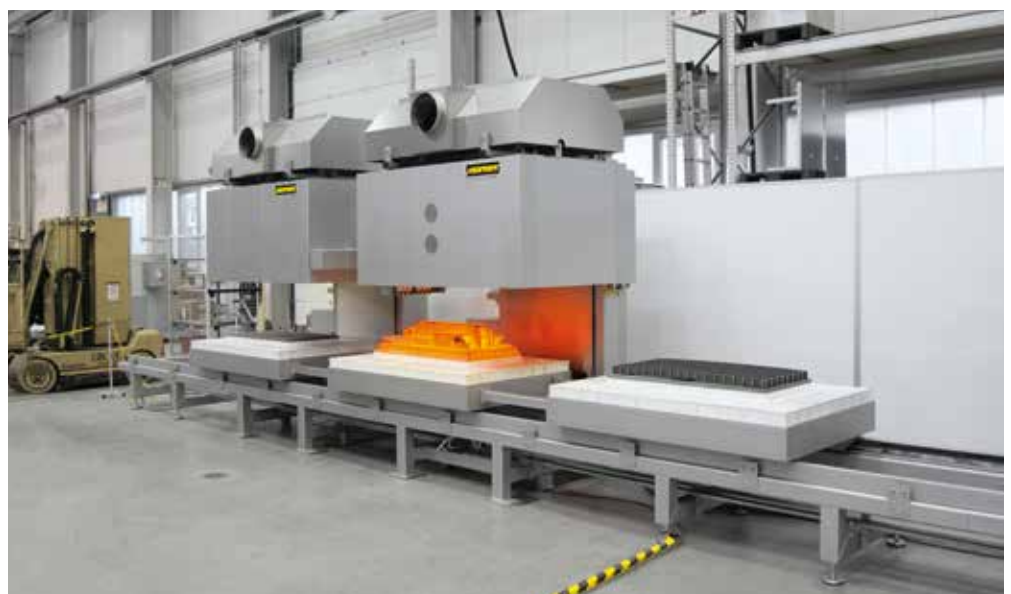
Equipo de temple automático compuesto por un horno de campana y dos campanas de refrigeración para la refrigeración forzada por aire (la segunda campana de refrigeración a la derecha no aparece en la imagen) con sistema de cambio de mesas
