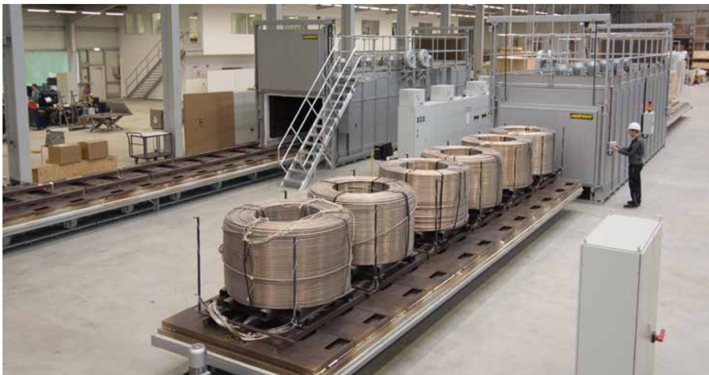
Horno de vagoneta de convección forzada W 24750/60AS para el recocido de bobinas de aluminio
