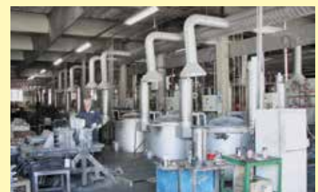
Quemador recuperador en hornos de fundición de aluminio 16 x TBR 110/12 y 2 x TBR 180/12
