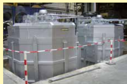
Hornos de cuba con circulación de aire SAH 5600/75 S en el dpto. de producción
