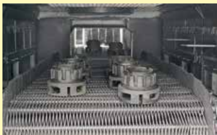
Banda transportadora de malla en horno continuo
