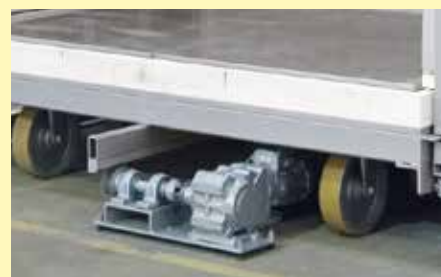
Vagonetas con ruedas de acero y engranajes de cremallera, sin colocación de rieles fuera del horno
