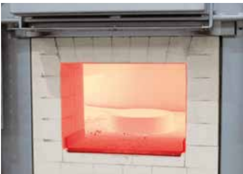
Precalentamiento de anillos de acero para forja en el horno de solera giratoria
