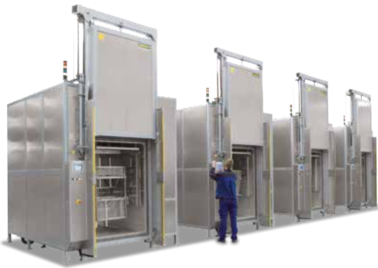
Instalación de producción, compuesta por cuatro secadores de cámara para mover la carga durante el proceso de tratamiento térmico e intercambiador de calor de tres etapas, para optimizar la eficacia energética
