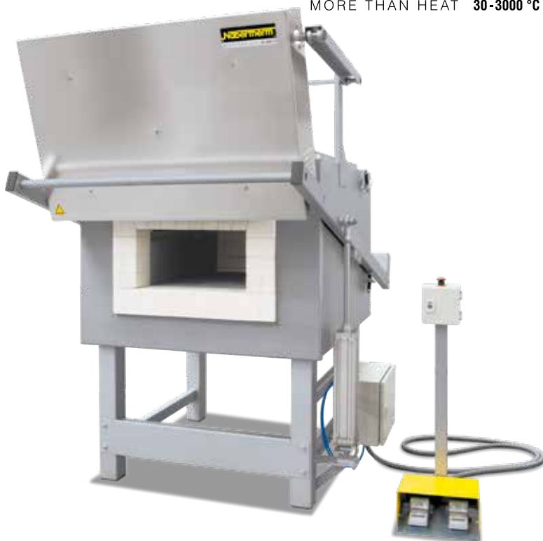
Horno de cámara N81/13 con puerta neumática de apertura vertical
