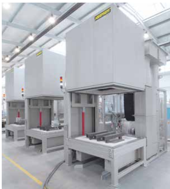
Instalación de producción, compuesta por 3 hornos de campana HAS 1560/95S con carcasa sellada para el funcionamiento en atmósfera de nitrógeno e intercambiador de calor de aire/gas para reducir los tiempos de enfriamiento
