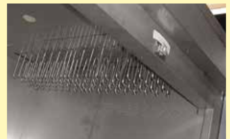
Registros calefactores en versión de calentamiento eléctrico con T máx 450 °C o 600 °C
