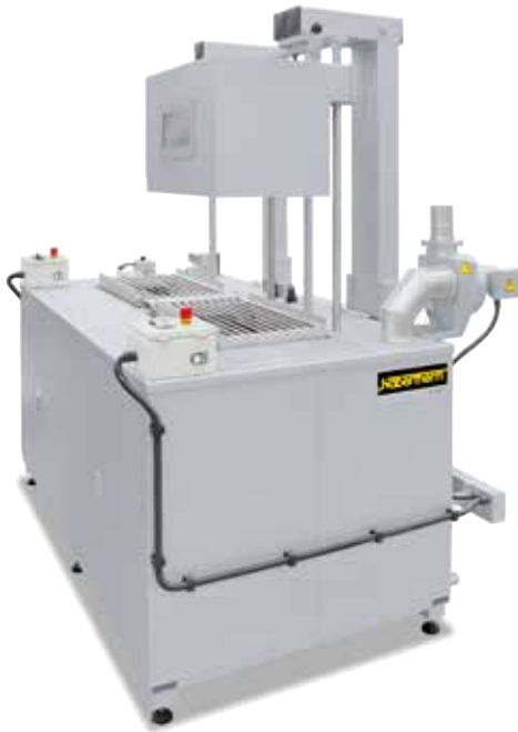
Baño de enfriamiento combinado de aceite y de limpieza, con mesas sumergibles, cubierta de protección, separador de aceite y aspiración
