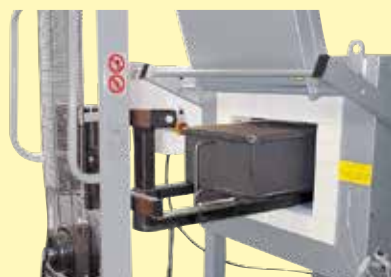
Trabajo con caja de inyección de gas para atmósferas de gas de protección con ayuda de un carro de carga
