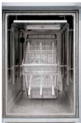
Dispositivo de giro a motor con cesto integrado para mover la carga durante el proceso de tratamiento térmico
