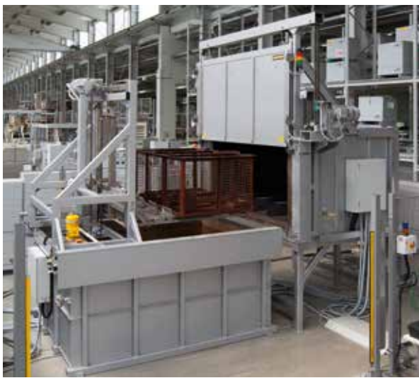
Equipo de temple horizontal compuesto por horno de cámara con circulación de aire, manipulador de dos ejes y baño de enfriamiento por agua
