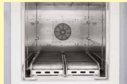
Rodillos en la cámara del horno
