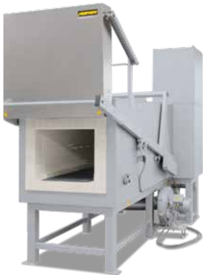
Horno de cámara NB 361/S
