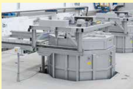
Hornos de cuba con circulación de aire S 10400/75 AS en el dpto. de producción
