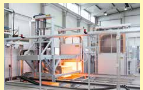
Equipo de temple totalmente automático para acero
