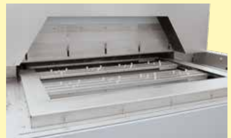
Horno continuo D 1000/1250/200/26AS para el templado de piezas modeladas por inyección
