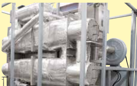
Intercambiador de calor de contracorriente en un horno de cámara con circulación de aire N 2560/26 ACLS
