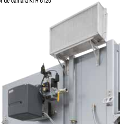
Calentamiento directo por gas en un secador de cámara
