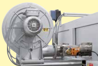
Ventiladores de refrigeración para favorecer el proceso de refrigeración
