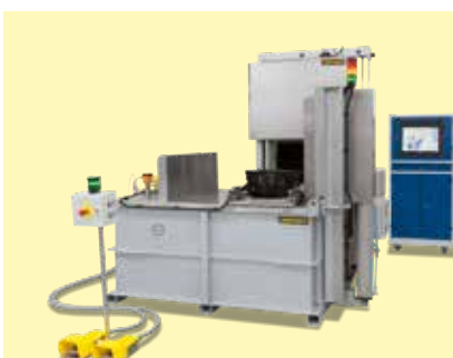
Equipo de temple semiautomático para aluminio
