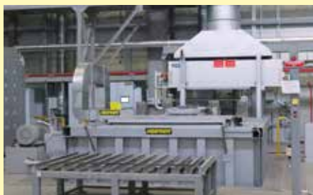
Baño de enfriamiento de aceite OAB 67000 con intercambiador de calor con una capacidad de 67.000 litros de aceite
