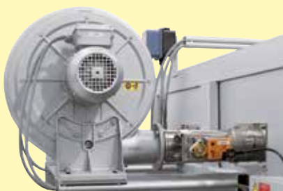
Kühlgebläse zum beschleunigten Abkühlen
