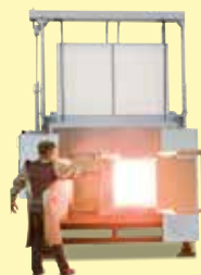
Kammerofen N 6080/13S als Vorwärmofen zum Schmieden mit Tür in der Tür
