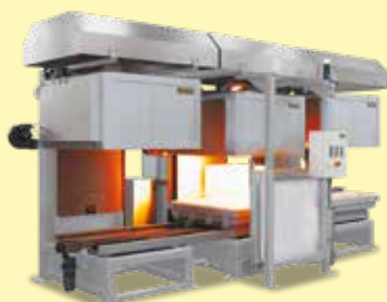
Haubenofenanlage H 245/LTS mit Kühlstation und Tischwechseleinrichtung
