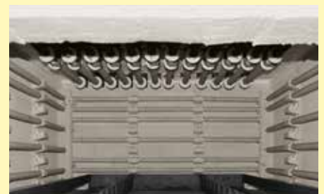
Ofenraum mit Deckenbeheizung als Zusatzausstattung bei Nutzung als Vorwärmofen für Blechplattinen
