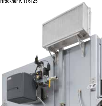
Direkte Gasbeheizung an einem Kammertrockner
