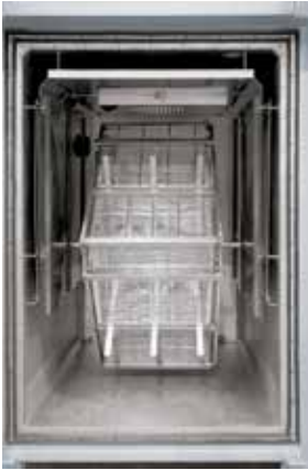
Motorisch angetriebenes Drehgestell mit eingesetzten Körben zum Bewegen der Charge während der Wärmebehandlung
