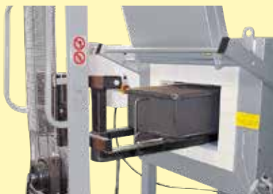
Arbeiten mit Begasungskasten für Schutzgasatmosphäre mit Hilfe eines Chargierwagens
