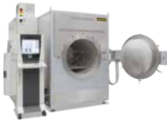
Heißwand-Retortenofen NR 300/09 zum Spannungsarmglühen von Metall-Bauteilen unter Schutzgas oder Vakuum nach dem 3D-Druck
