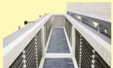
Ofenraum S 5120/GS mit Aufnahme der Isolierplatte zum Halbieren des Ofenraumes
