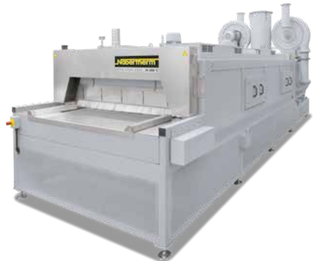
Durchlaufofen D 1500/3000/300/14 zum thermischen Altern mit Maschengurt und nachgeschalteter Kühlstation
