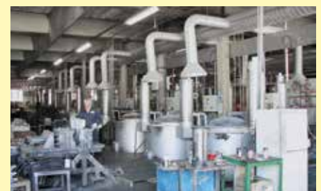
Rekuperator-Brenner an Aluminium-Schmelzöfen 16 x TBR 110/12 und 2 x TBR 180/12
