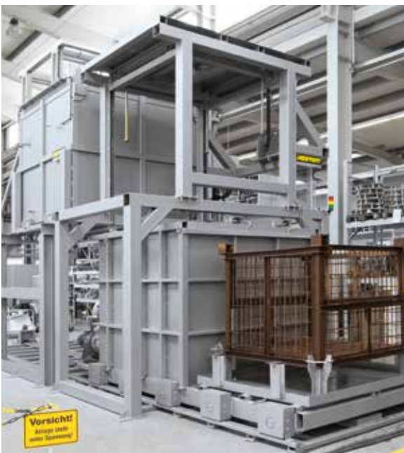
Vollautomatische Fallschachtofenanlage mit Endladekran (Variante B)
