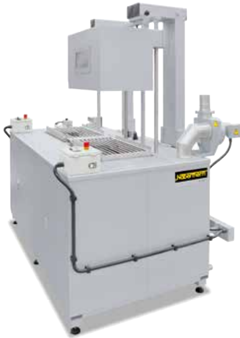
Kombiniertes Öl-Abschreck- und Reinigungsbad mit absenkbareren Tischen, Schutzhaube, Ölabscheider und Absaugung
