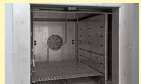
Innenraum mit Einlegeblech, Thermoelementen und Drucküberwachung
