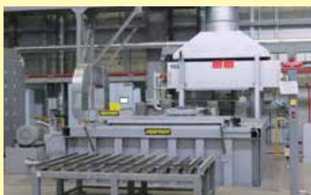
Ölabschreckbad OAB 67000 mit Wärmetauscher mit einem Inhalt von 67.000 Litern Öl
