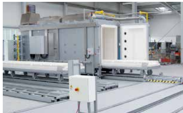
Kombiofenanlage, bestehend aus einem gasbeheizten Herdwagenofen WB 11000/HS, Herdwagenverschiebesystem und zwei zusätzlichen Herdwagen inkl. der benötigten Abstellgleise
