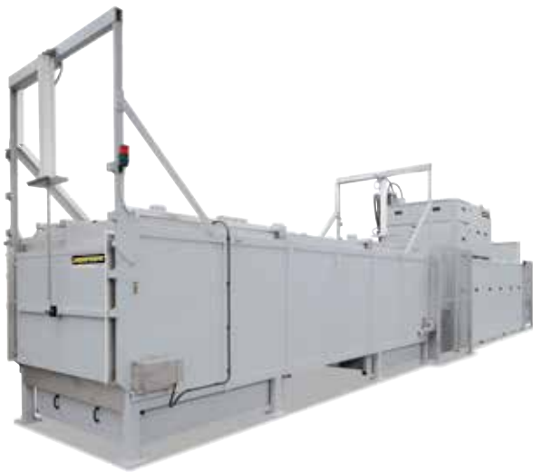
Durchlaufofenanlage D 1600/6100/800/26AS gemäß EN 1539 mit Kühlstation KS 1600/6100/800/AS zur Vulkanisierung von Schläuchen
