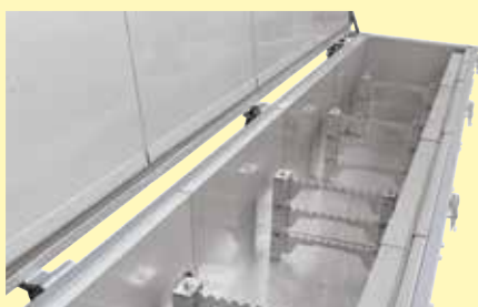
Chargenaufgabe für lange Rohre in einem Umluft-Truhenofen SAL 750/08
