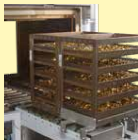
Durchlaufofen für Schüttgut in Körben
