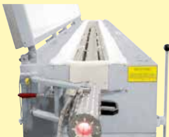
Drahtdurchziehofen auf Basis eines Rohrofens mit einer Länge von 6 Metern
