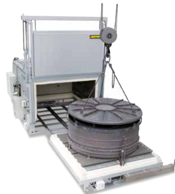
Umluft-Herdwagenofen W 5290/85AS mit Begasungskasten zur Wärmebehandlung von Rollenmaterial unter Schutzgas
