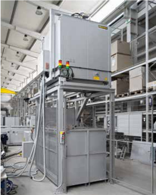
Fallschachtofenanlage mit feststehendem Abschreckbad (Variante A)
