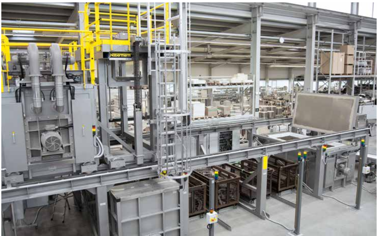
Verfahrbare Fallschachtofen zum Lösungsglühen mit Schachtofen zum Warmauslagern mit vier Stellplätzen
