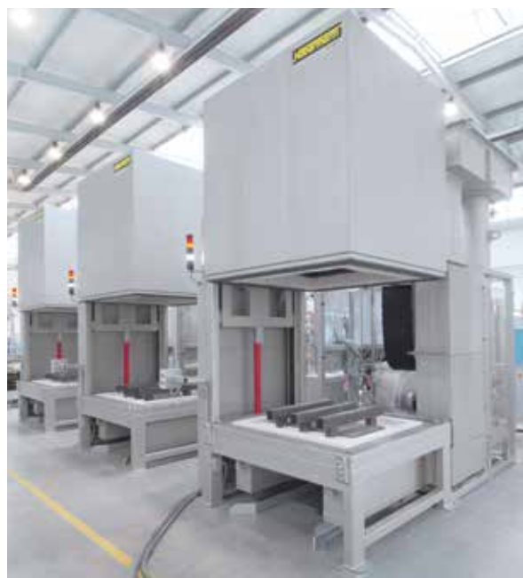
Produktionsanlage, bestehend aus 3 Haubenöfen HAS 1560/95S mit abgedichtetem Gehäuse für den Betrieb unter Stickstoff und Luft/Gas-Wärmetauscher zur Verkürzung der Abkühlzeiten
