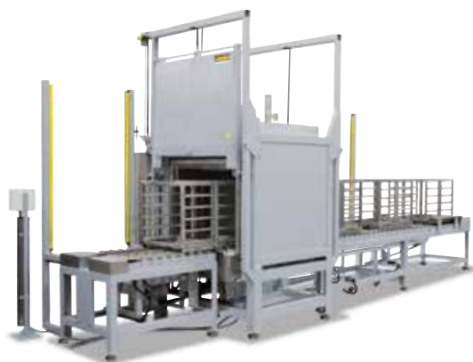
Rollendurchlaufofen N 650/45 AS für die Wärmebehandlung schwerer Bauteile
