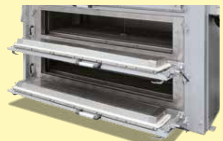
Mehrkammerofen NA 4400/26 für unterschiedliche Haltezeiten
