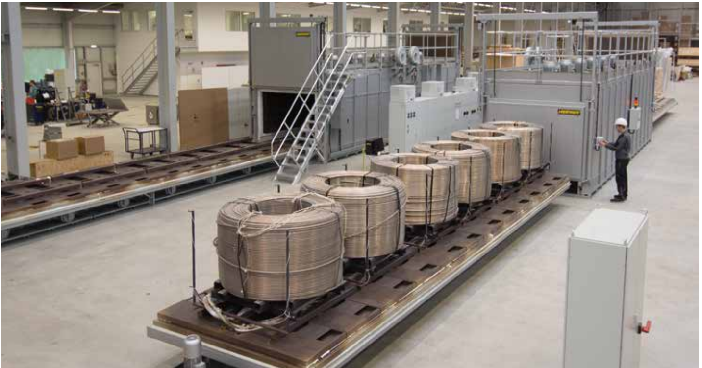
Umluft-Herdwagenofen W 24750/60AS für die Wärmebehandlung von Coils aus Aluminium
