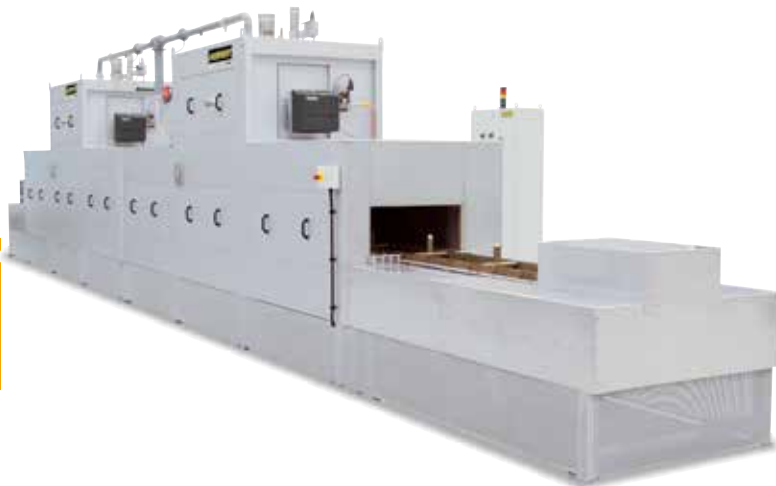
Durchlaufofen D 700/10000/300/45S mit Förderkette für 950 °C, gasbeheizt
