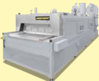
Durchlaufofen D 1500/3000/300/14 mit Maschengurt und nachgeschalteter Kühlstation
