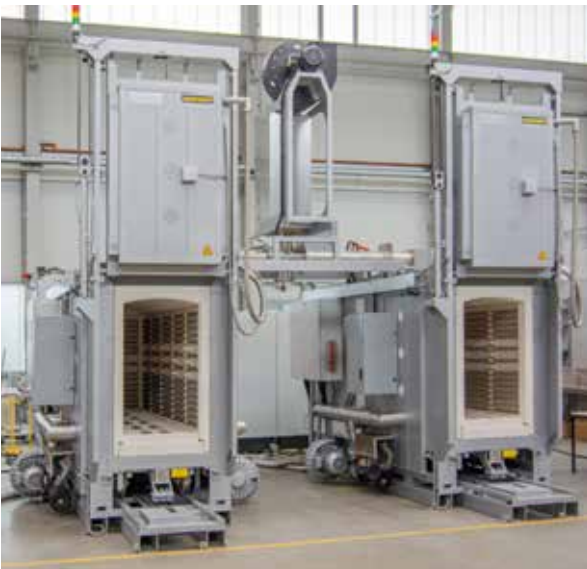
Dos hornos de vagoneta combinados W 2254/14 DB200-4 con postcombustión catalítica para funcionamiento alterno
