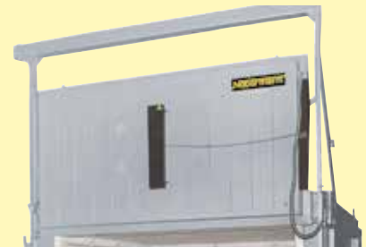
Puerta de elevación de accionamiento electrohidráulico
