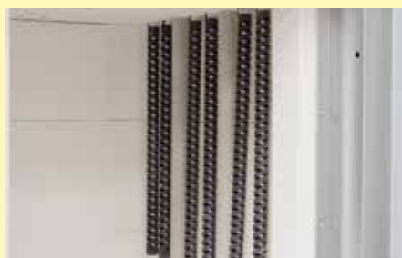
Barras SiC suspendidas verticalmente y opcionalmente tubos de entrada per-forados para sistema de debinding en un horno de alta temperatura
