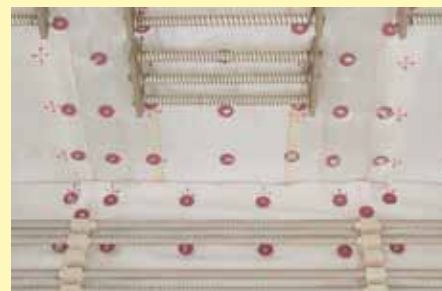
Cubierta de tejido en la tapa de fibra (y laterales) para reducir el polvo generado por la fibra
