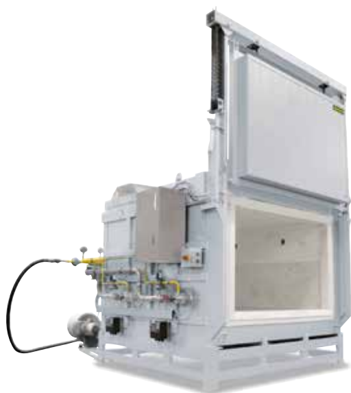
Horno de cámara NB 4330/S
