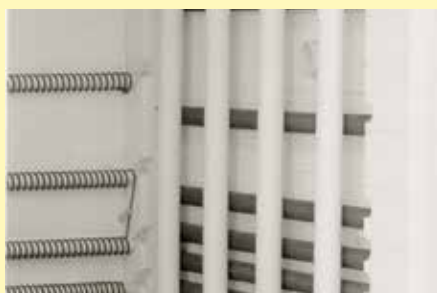
Inyección de aire precalentado a través de tubos cerámicos perforados
