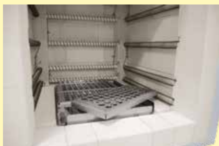
Rejillas de carga en la solera
