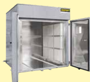
KTR 8000 como horno de producción en sala limpia con filtros para la circulación de aire
