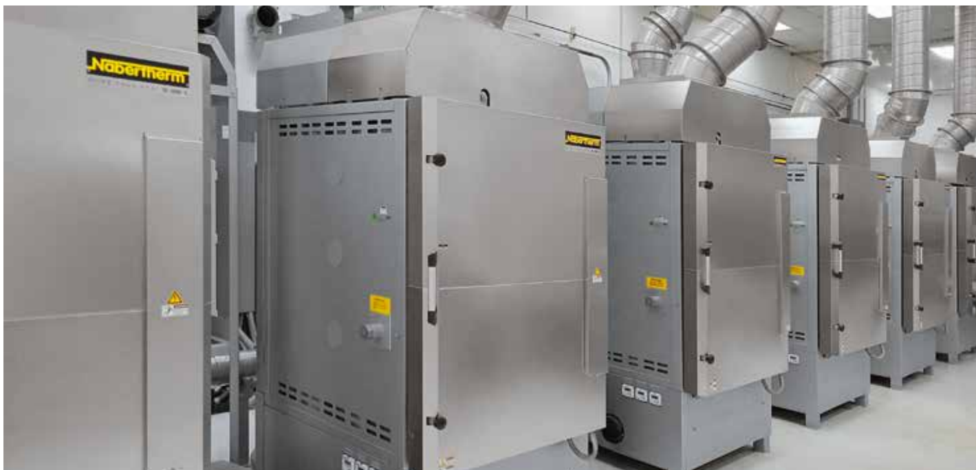
Instalación de producción compuesta por hornos de cámara combinados N 650 DB200 con postcombustión catalítica para funcionamiento alternativo.
