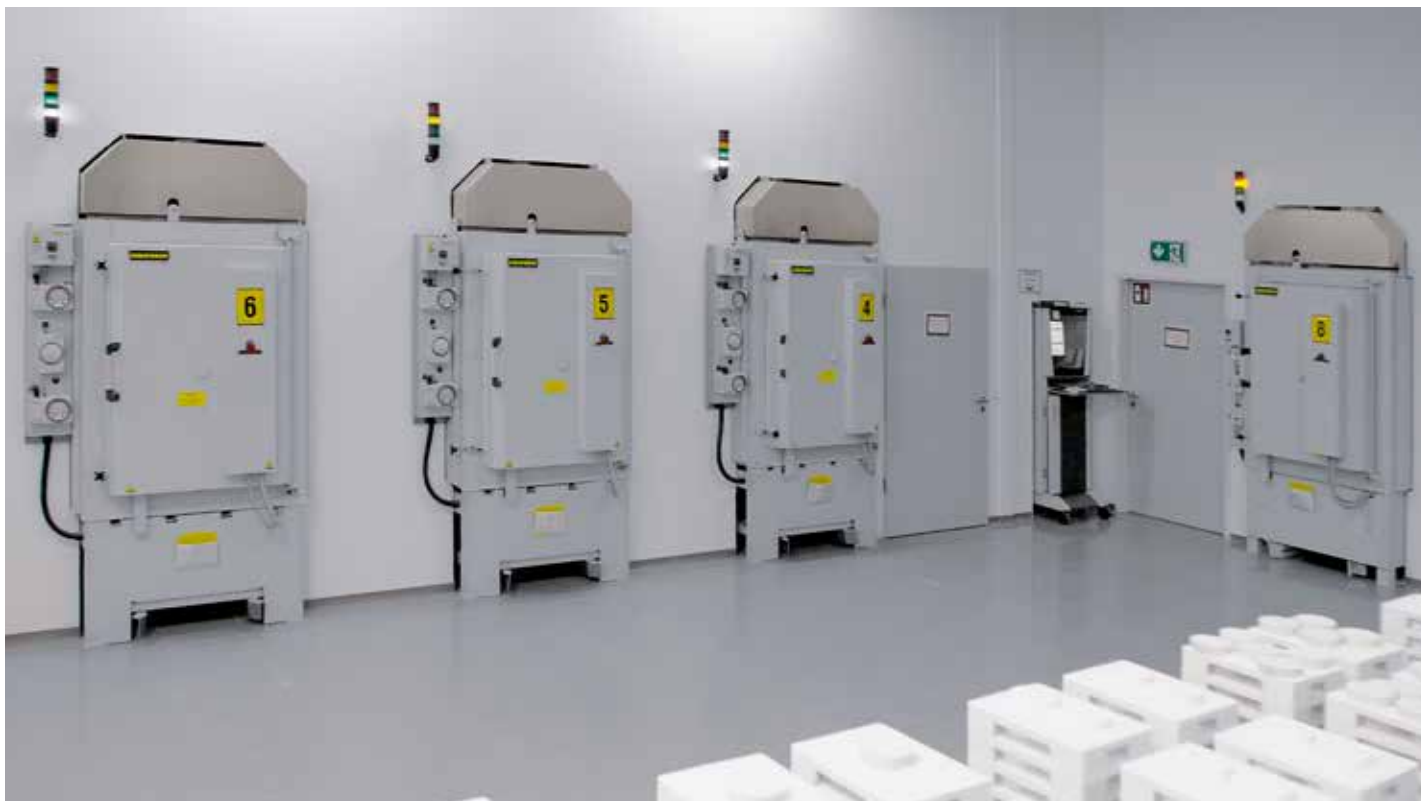
Hornos de cámara combinados N 650 DB 200-3 para desaglomerado y sinterizado en versión de sala limpia/sala gris
