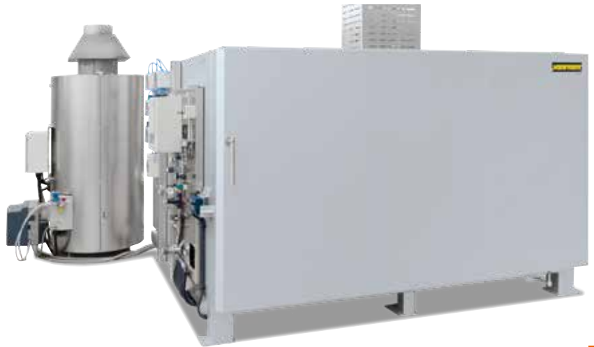
Horno de cámara con circulación de aire NA 4000/60B DB200 para desaglomeración al aire con postcombustión térmica TNV 300
