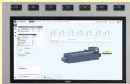
Monitorización de todos los valores configurables mediante NCC (p.e. monitorización de la temperatura de las distintas zonas, caudales de los gases, etc)
