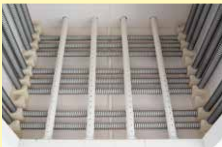
Tubos de entrada de aire para un suministro homogéneo de aire fresco en la desaglomeración
