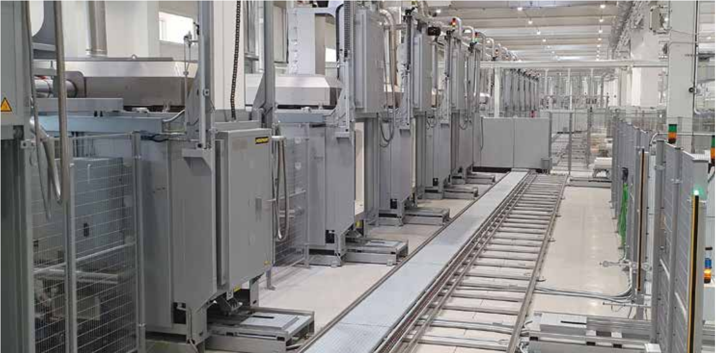
Instalación con seis hornos de vagoneta W 2254/14 DB200-3 con postcombustión catalítica pcon funcionamiento alternativo, puerta de elevación y sistema de transferencia con estación de carga y descarga para el modo automático
