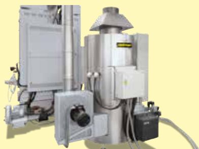
Postcombustión térmica o catalítica disponible como opción (en la imagen: postcombustión térmica)
