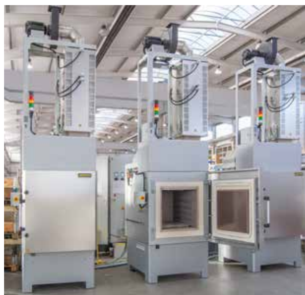
Instalación de producción con tres hornos de cámara con circulación de aire NA 250/85 DB200 para desaglomeración y postcombustión catalítica PCC KNV 320 (construcción de superficie reducida)
