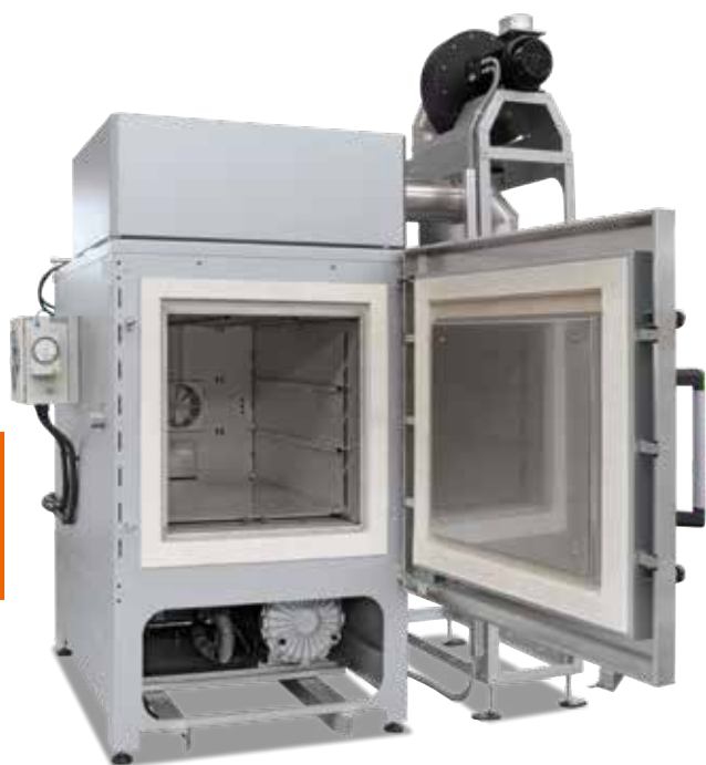
Horno de cámara con circulación de aire NA 500/85 DB200-3 con paquete de seguridad para desaglomerar con aire y postcombustión térmica
