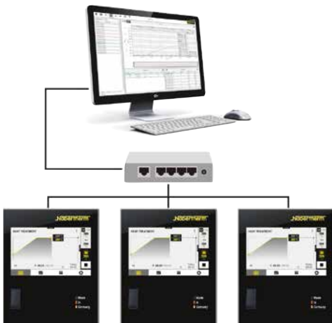
Ejemplo de instalación con 3 hornos
