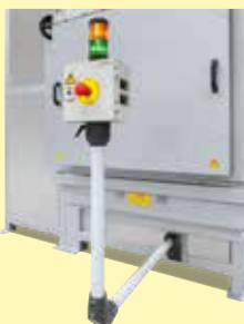
Operación a dos manos con brazo giratorio
