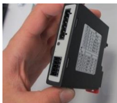
Att. 11: regulēšanas moduļu montāža (skatīt attēlu)
