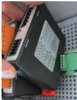
Att. 10: regulēšanas moduļu demontāža – 2. daļa (skatīt attēlu)
