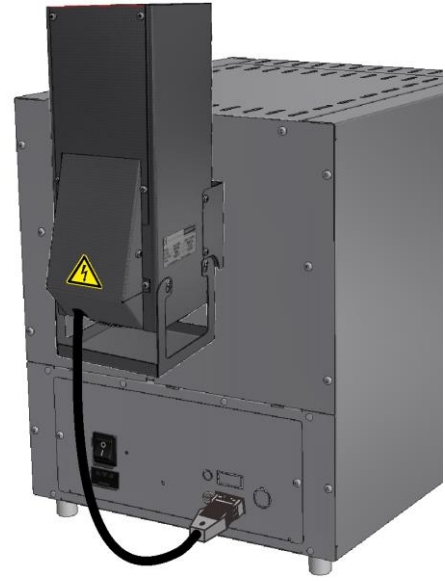
催化器： 用于清除废气中的有机成分。有机成分在600 °C左右的温度下通过催化反应被燃烧掉，即分解成二氧化碳和水蒸气。从而，废气中不会有气味产生。催化器通过控制器B510 - P580进行程序性调控(不适于炉型L(T) 15.., L 1/12, LE 1/11, LE 2/11)。*
