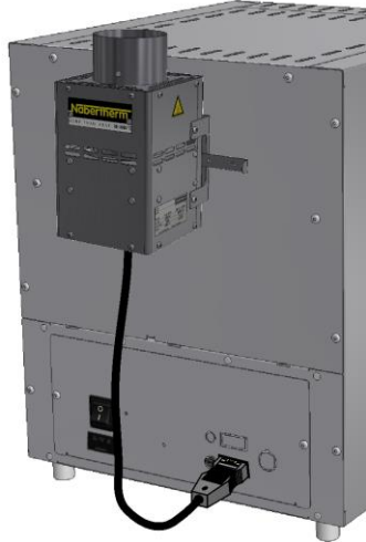
带排风扇的排气烟囱： 用于改善炉内废气排放。通过控制器B510 - P580进行程序性调控(不适于炉型L(T) 15.., L 1/12, LE 1/11, LE 2/11)。*
