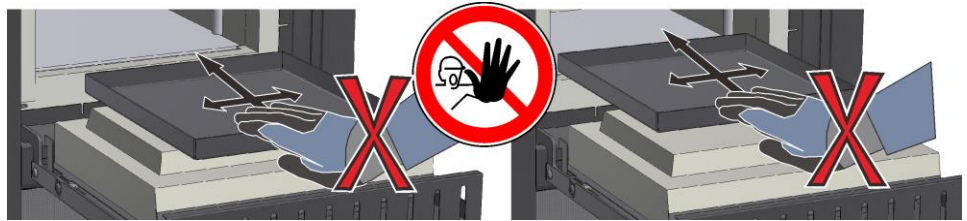
图示36：示例：应防止门保温层受损(与插图相似)
