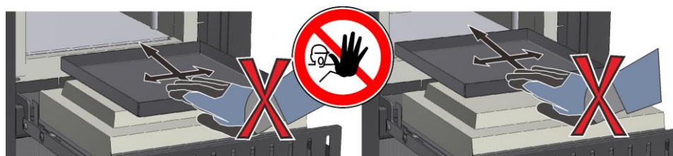
Fig. 36: Exemplu: Evitați deteriorarea izolației ușii (figură similară)
