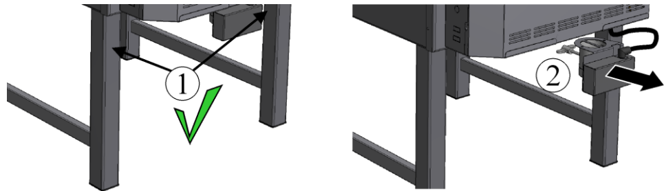
Sl. 52: Izvlačenje poklopca ulaznog zraka iz nosača (slično kao na slici)
