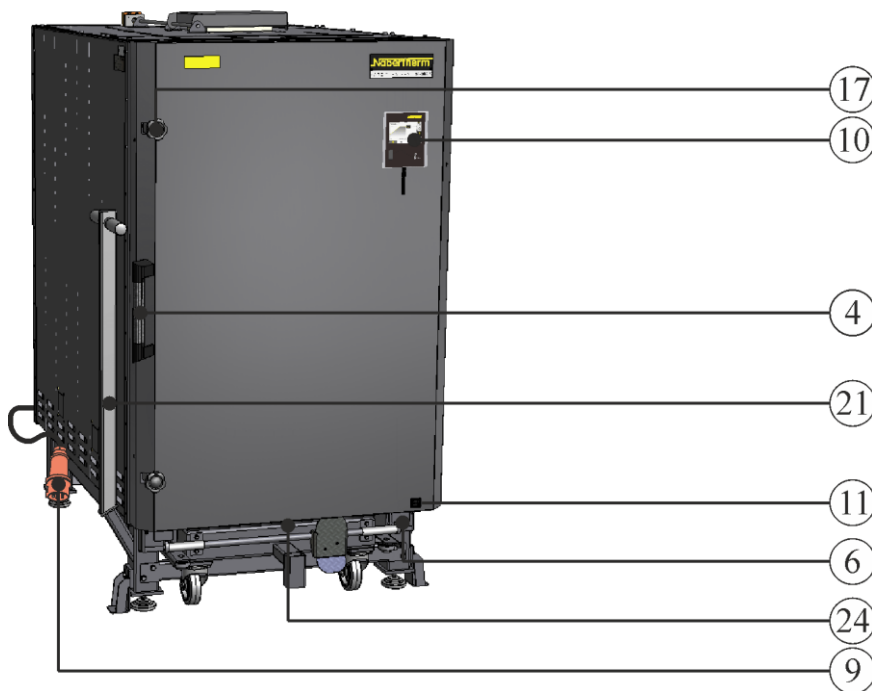
Fig. 5 : Exemple : Four chambre à sole mobile amovible
