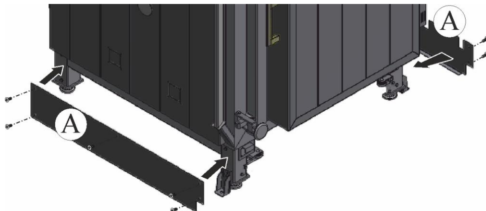
Fig. 46: Montage des tôles latérales (figure analogue)
