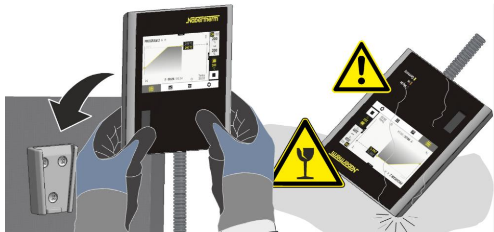
Fig. 55: Mettre le programmeur en place sur le support fixé sur le four (figure analogue)
