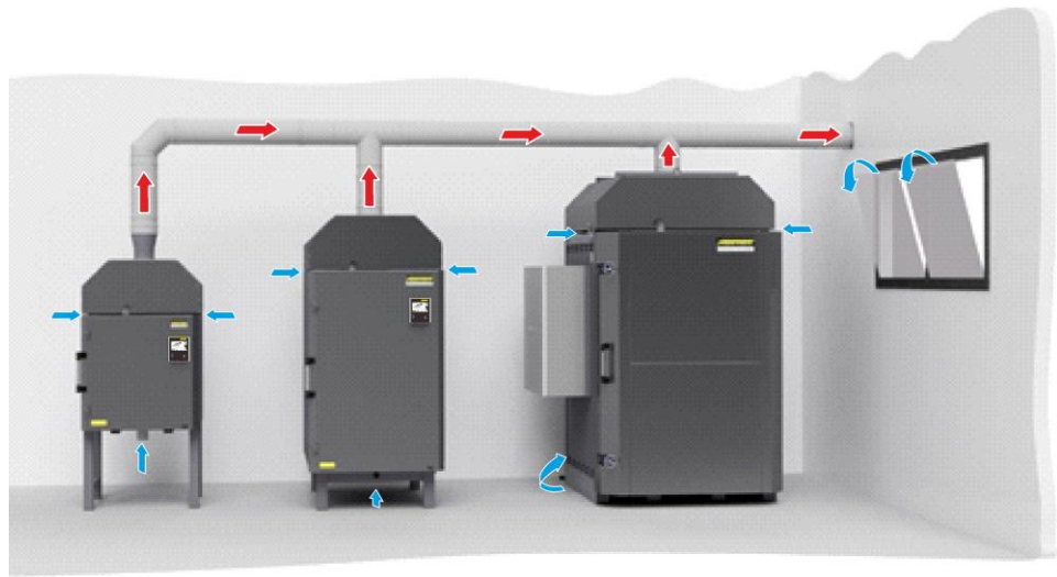
Fig. 58 : Exemple d'un système d'aspiration actif (figure en fonction du modèle)
