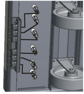
Exemple : Bornes des éléments chauffants sole mobile
