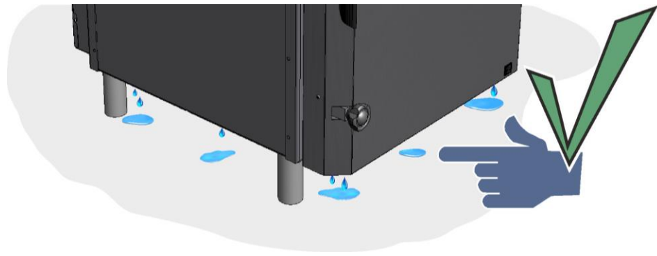
Fig. 67: Kondensansamlinger under de første brenningene (illustrasjonen kan avvike)
