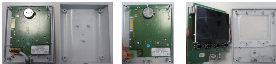
Obr. 13: Demontáž základní desky kontroléru – část 2 (přibližný obrázek)
