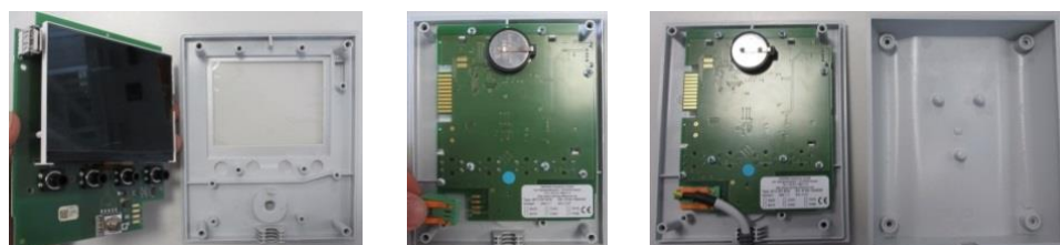
Obr. 15: Montáž základní desky kontroléru – část 2 (přibližný obrázek)
