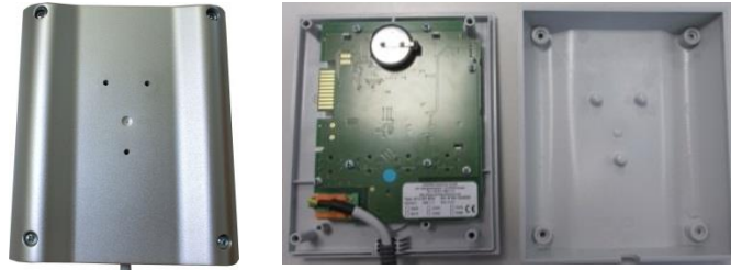
Obr. 11: Výměna kontroléru (přibližný obrázek)
