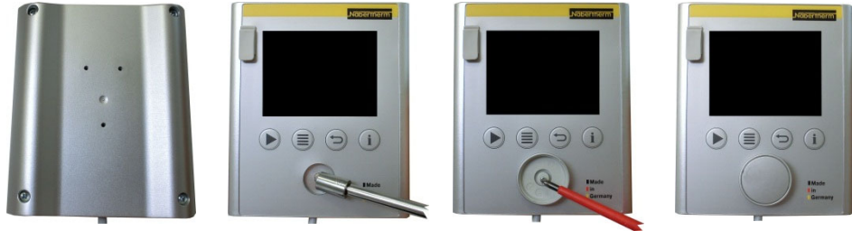
15 pav.: Regulatoriaus kortelės montavimas – 3 dalis (panašus pav.)
