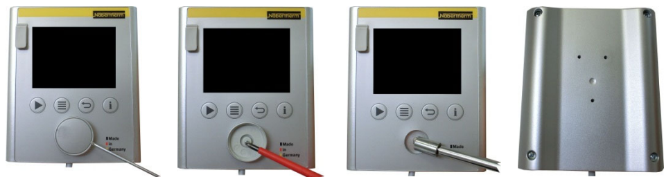
11 pav.: Reguliatoriaus kortelės išmontavimas – 1 dalis (panašus pav.)
