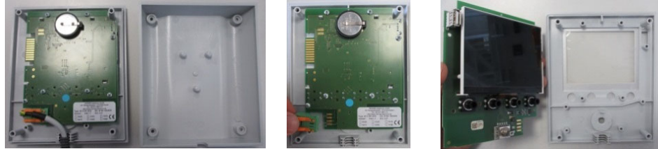
12 pav.: Reguliatoriaus kortelės išmontavimas – 2 dalis (panašus pav.)
