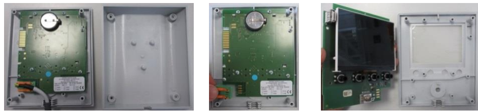
Рис. 13. Демонтаж платы контроллера. Часть 2 (изображение приближенное)
