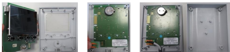
Рис. 15. Монтаж платы контроллера. Часть 2 (изображение приближенное)
