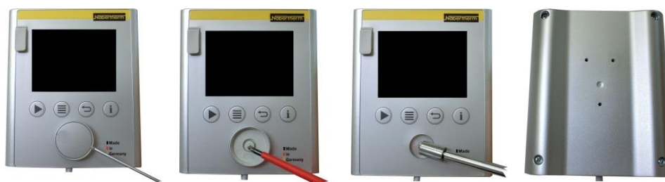
Рис. 12. Демонтаж платы контроллера. Часть 1 (изображение приближенное)
