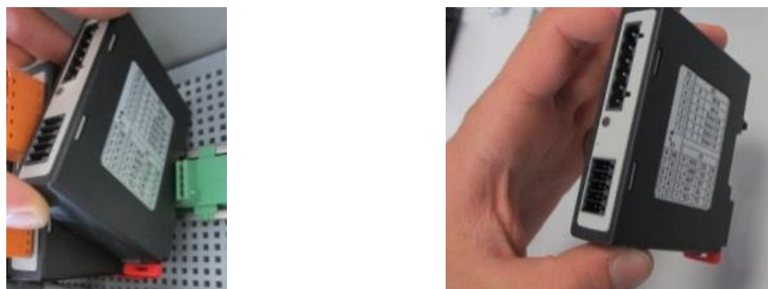
Рис. 18. Демонтаж модулей регуляторов. Часть 2 (изображение приближенное)
