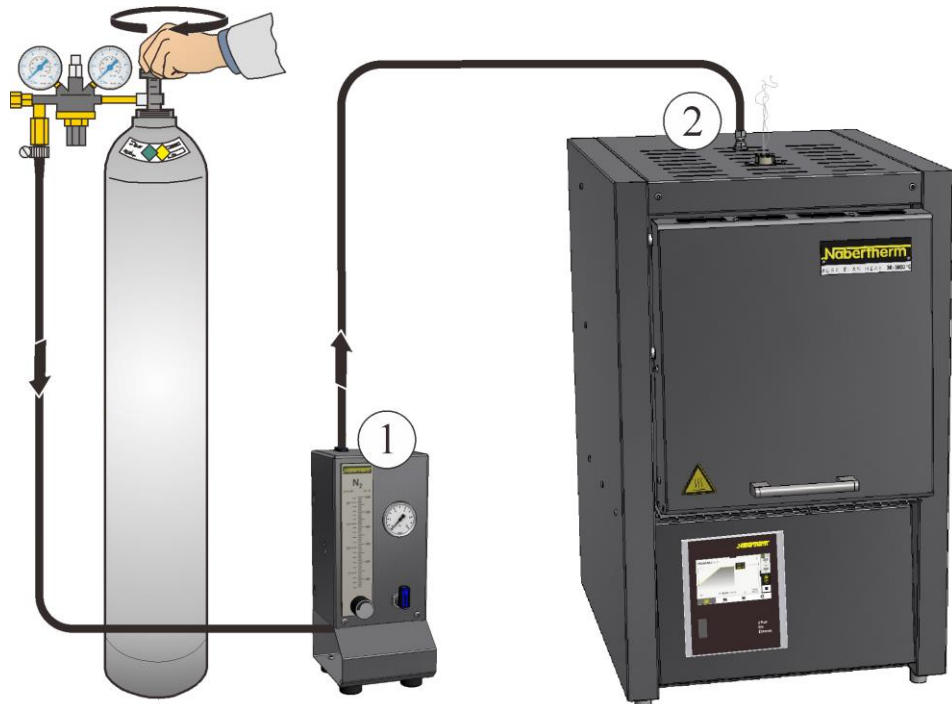
Fig. 57: Tilkobling på gassforsyningssystemet (illustrasjonen kan avvike)
