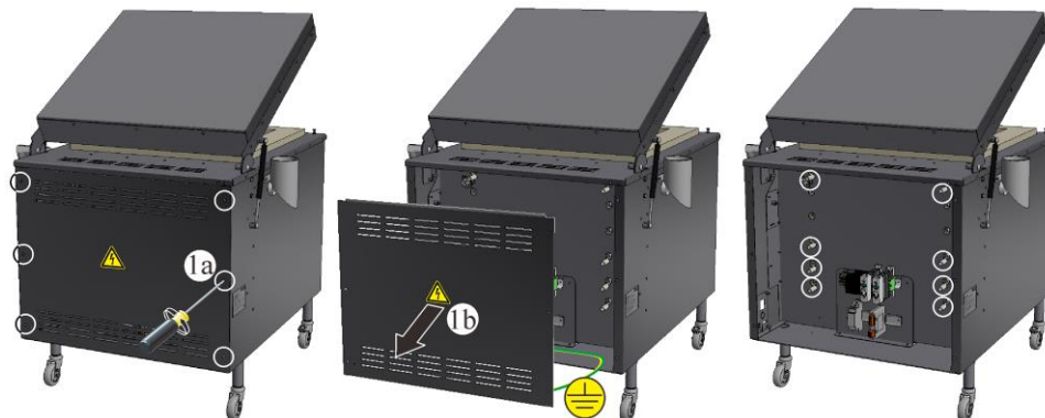
Fig. 75: Demontați capacul instalației de comutare de pe partea posterioară a cuptorului (ca în imagine)
