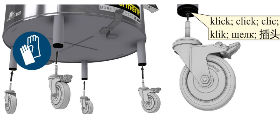
Fig. 15: Montarea rolor de transport (similar cu figura)
