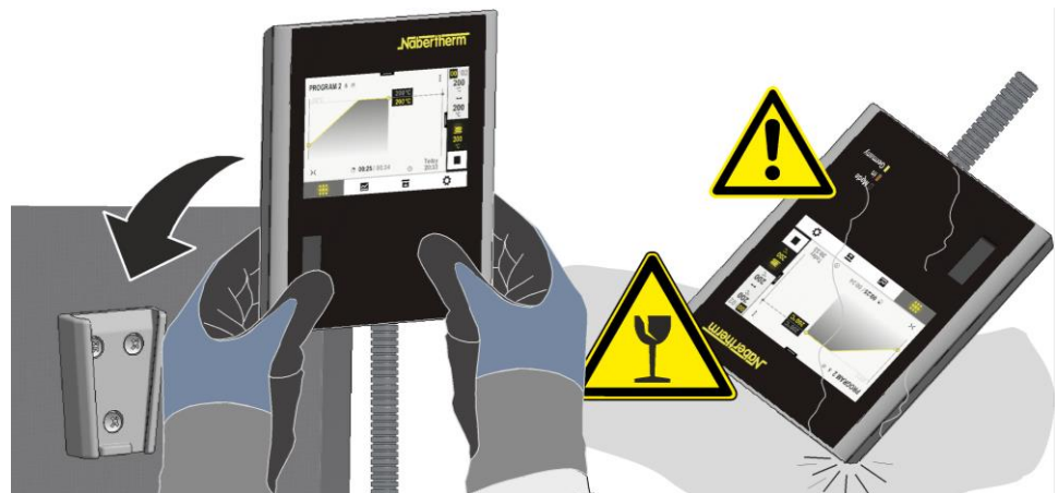
Fig. 33: Introduceți controllerul în suportul aflat pe cuptor (ca în imagine)
