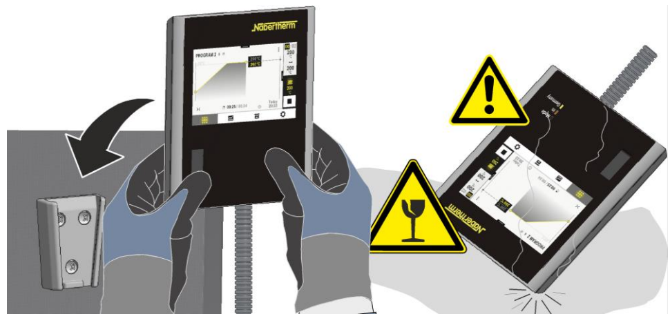
Fig. 33: Insertar el controlador en el soporte ubicado en el horno (figura análoga)
