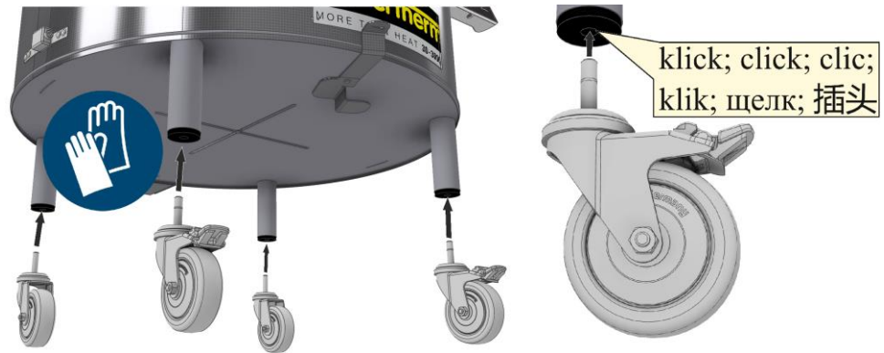
Fig. 15: Montaje de las ruedas de transporte (figura análoga)
