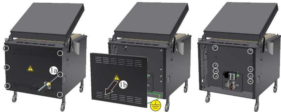
Fig. 75: Desmontar la tapa de la instalación de distribución de la cara posterior del horno (figura análoga).
