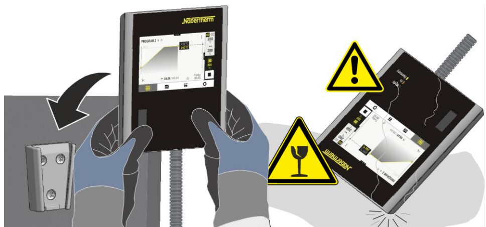
Fig. 21: Insertar el controlador en el soporte ubicado en el horno (figura análoga)
