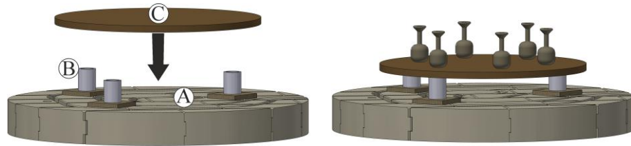
Fig. 41: Situar la placa integrada (C) sobre los soportes integrados (figura análoga)
